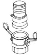
RX = Бърза връзка (неръждаема стомана 304 и 316L) RX = Racor rápido (acero inoxidable AISI 304 y 316L)
